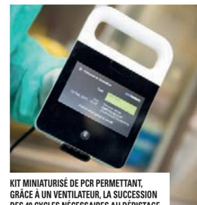
KIT MINIATURISÉ DE PCR PERMETTANT, GRÂCE À UN VENTILATEUR, LA SUCCESSION DES 40 CYCLES NÉCESSAIRES AU DÉPISTAGE.
